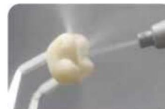
Arenar a menos de 2-2.5Bar con arena 50µm AL O3.
